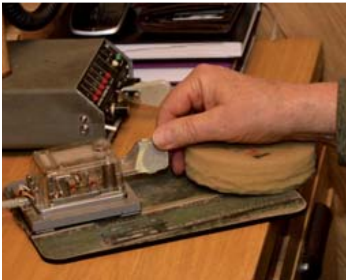
Kaum sichtbar ist die Bewegung zwischen Daumen und Zeigefinger, die Punkte und Striche sendet.
